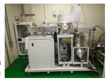
情形下能可產生高密度電漿,而另一個射頻電源則是在蝕刻時產生一偏壓。搭配不同氣體選擇,可以有效達到對不同膜層的蝕刻,本儀器有提供O2、CF4、CO、NH3,可以用於磁性材料之圖形化的製程作業。
